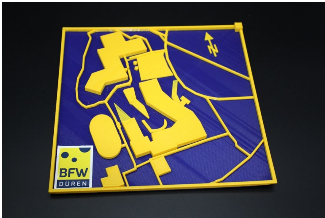
Figura 6 Il file STL stampato. Telaio e marcatore di posizione sono visibili.
